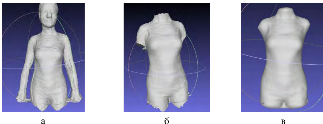
Рис. 2. Трехмерная модель фигуры: а- сканированная; б, в – обработанная фильтрами программы
