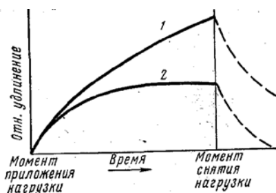
Рис.3. Изменение относительного удлинения аморфного полимера при \sigma = \text{const} 1 – линейный полимер; 2 – трёхмерный полимер
