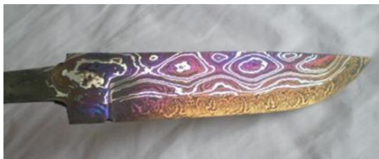
Рис. 1. Декорирование лезвия ножа методом оксидирования при повышенной температуре. Работа мастера – Емченко из г. Златоуст.
