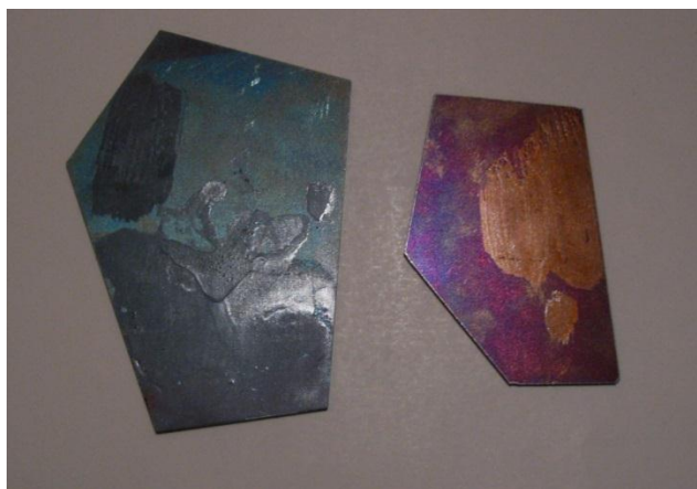
Рис. 5. Дефект лакокрасочного покрытия на оксидированной заготовке
