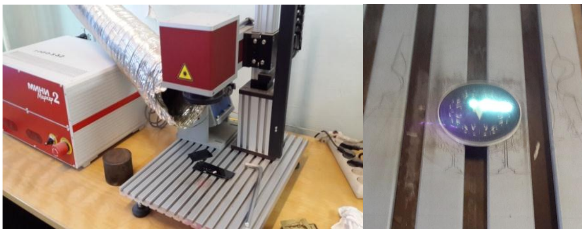
Рис.5. Лазерная гравировка оберега на установке «Минимаркер2».
