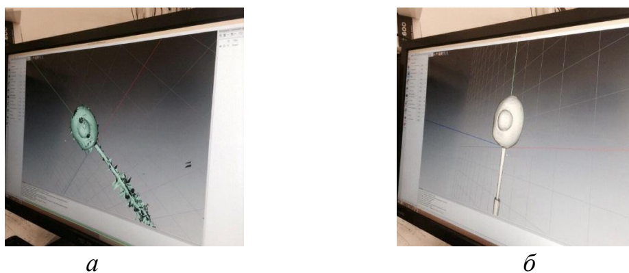
Рисунок 5. Завершающий этап получения матрицы: а – резкие угловатые поверхности и плоскости свидетельствуют о ещё не завершённом просчете матрицы поверхности объекта; б – конечный вид полученной модели объекта
