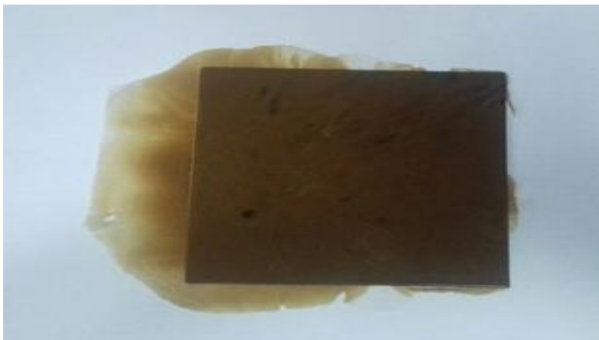
Рисунок 2. Образец композиционного материала (PLA + древесная мука)
