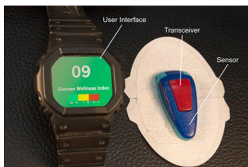
Рисунок 9. Устройство-бижутерия компании Glucovation, предназначенное для мониторинга сахара в крови.
