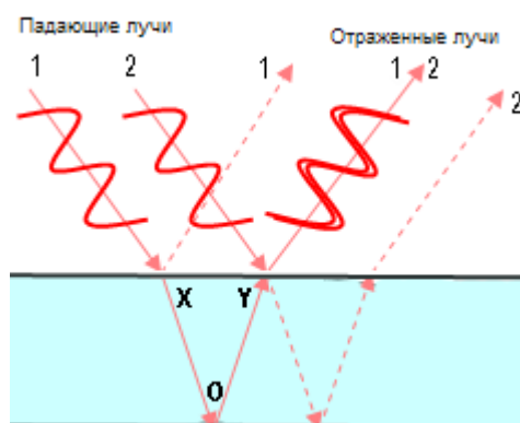
Рисунок 1. Схема интерференции света в тонкой оксидно-металлической плёнке
