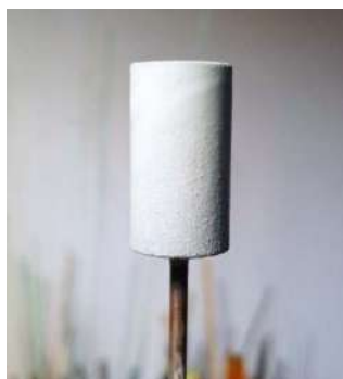
Рисунок 1. Мандрель, покрытая сепаратором Figure 1. Mandrel covered with separator
