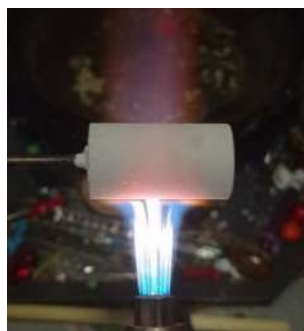
Рисунок 2. Прогревание мандрели в огне Figure 2. Warming up the mandrel in the fire
