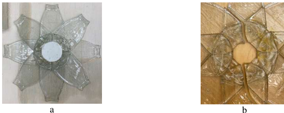
Рисунок 5. Обжиг при 780°C а – до обжига; б – после обжига Figure 5. Firing at 780°C а – before firing; б – after firing
