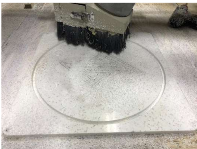
Рисунок 3. Резка контура циферблата станком Figure 3. Cutting the contour of the dial with a machine
