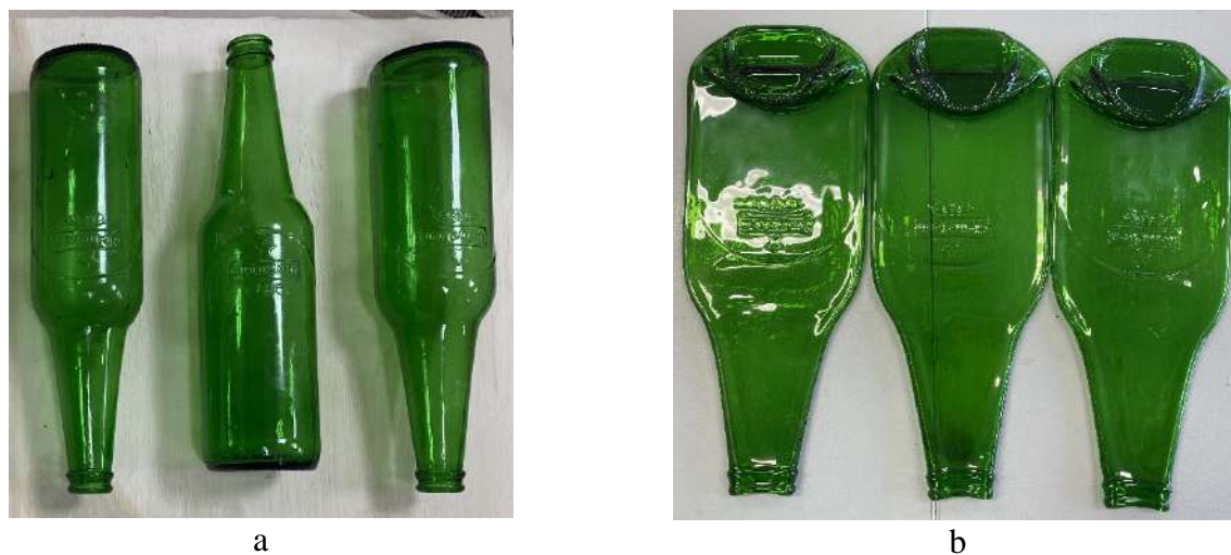
Рисунок 4. Обжиг при 750^\circ\text{C} а – до обжига; б – после обжига Figure 4. Firing at 750^\circ\text{C} а – before firing; б – after firing
