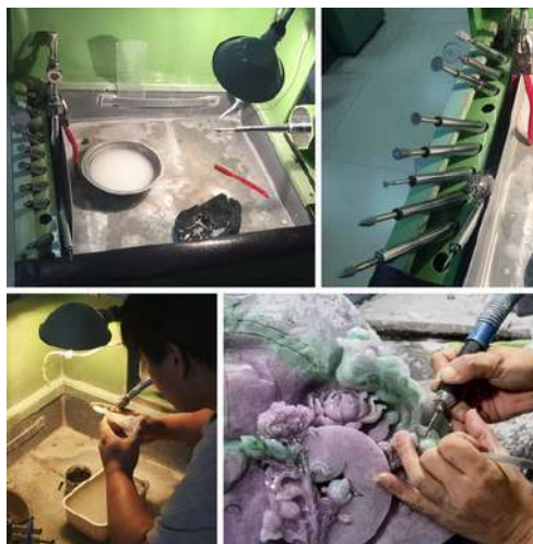
Рисунок 7. Современный роторный станок используется в процессе резьбы по нефриту [7]
