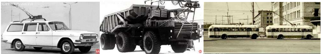
Удивительные советские изобретения (слева – направо): автомобиль-троллейбус, троллейбус-БелАЗ, троллейбусный поезд им. Владимира Веклича
